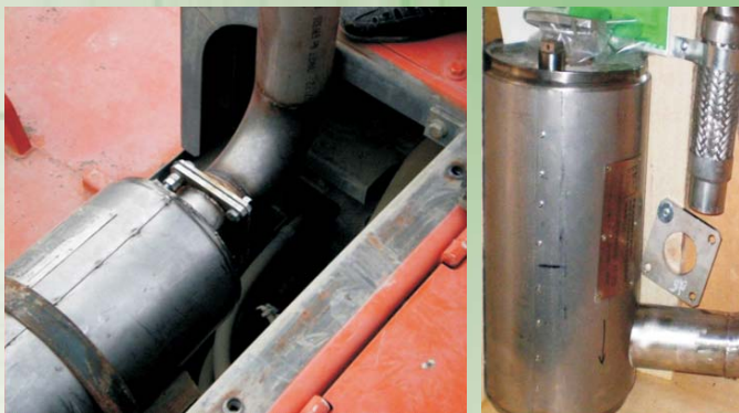
Фото 1. Нейтрализатор, смонтированный в выхлопной тракт
