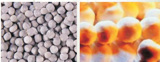
Фото 2. Гранулированный платиносодержащий катализатор ШПК-1
