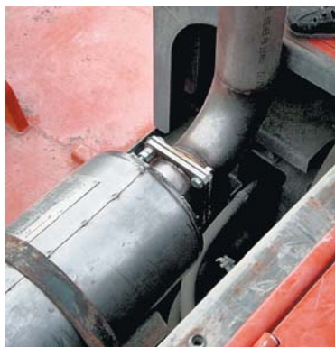
Нейтрализатор, смонтированный в выхлопной тракт
