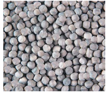
Гранулированный платиносодержащий катализатор ШПК-1
